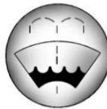
打开上面有清洗器符号的盖子。将储液罐加满清洗液。关于储液罐位置，请参阅发动机舱概览 ▷ 258。
