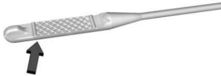
如果机油低于机油尺尖端的交叉影线区域且发动机已关闭至少 15 分钟，则添加 1 升（1 夸脱）推荐的机油，然后重新检查油位。关于使用哪类机油的说明，请参阅本章节中后面的“选择正确的发动机机油”。关于发动机机油曲轴箱容量，请参阅容量和规格 ◆ 328。
