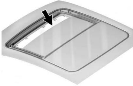
灰尘和碎屑可能聚集在天窗密封件或导轨内。这可能会导致天窗操作问题或产生噪音。也可能会堵塞排水系统。定期打开天窗并清除障碍物或松散的碎屑。使用清洁布、中性肥皂和清水清洗天窗密封或车顶密封区域。
