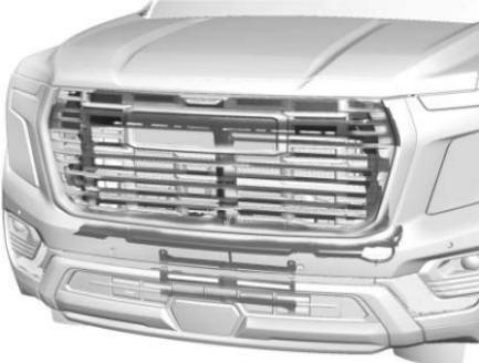
车辆可具有旨在帮助提高燃油经济性的格栅系统。保持格栅系统无碎屑和冰雪。如果格栅系统堵塞，检查发动机指示灯可能会亮起。
