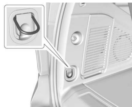
后备箱区域中配有两个货物系紧装置。这些装置可用于系紧货物，防止货物在车内移动。
