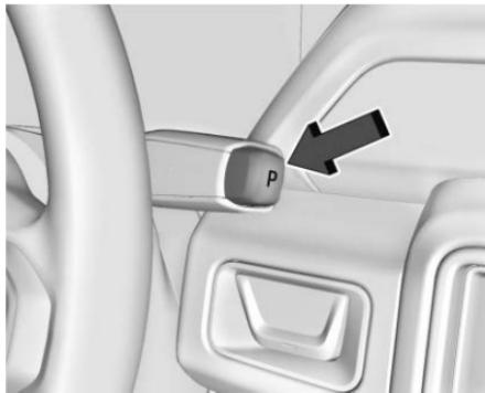
**P**：该挡位可锁定驱动车轮。启动车辆时选用 P（驻车）挡，确保车辆不会移动。
