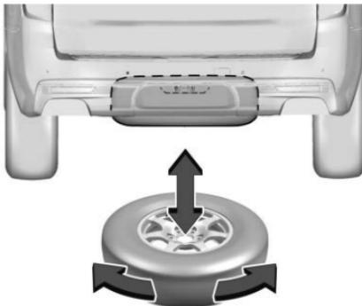
7. 确保备胎存放牢固。推、拉备胎，然后尝试转动轮胎。如果轮胎移动，则用车轮扳手拧紧拉线。
