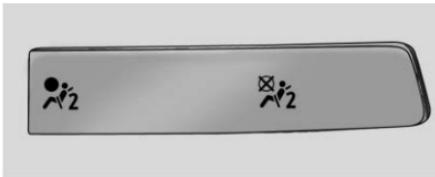
该车辆具有用于前排副驾驶席位置的乘客感应系统。当车辆启动时，顶置控制台上的乘客安全气囊状态指示灯将会点亮。
