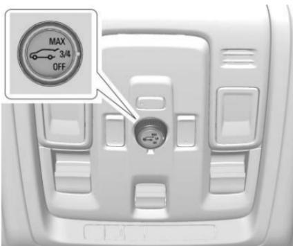
电动尾门开关（如配备）位于顶置控制台上。车辆必须位于 P（驻车）挡。
