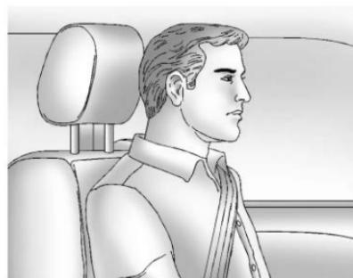
调整头枕使头枕的顶部与乘员的头顶齐平。这个位置可以降低碰撞中的颈部伤害风险。
