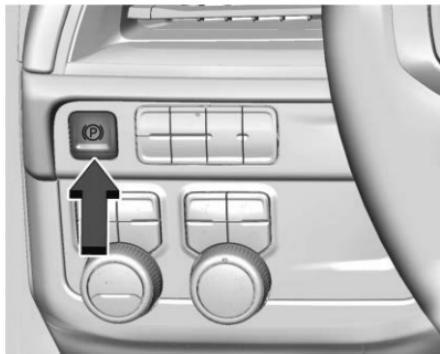
可在车辆熄火时启用电子驻车制动器 (EPB)。如果没有足够的电力，无法启用或松开电子驻车制动器。为防止蓄电池电量耗尽，避免不必要地来回启用和停用电子驻车制动器。
