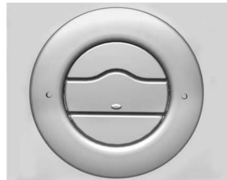
按下中央叶片后缘可打开圆形出口。使用中央叶片旋转出口并改变气流方向。按下中央叶片前缘可关闭气流。
