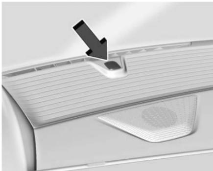
挡风玻璃附近仪表板顶部的日光传感器监测太阳热量。
