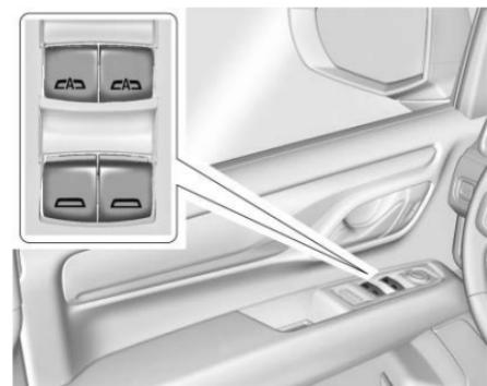
当车辆置于“ON (点火)”位置、处于辅助电源模式或延时辅助电源模式 (RAP) 处于激活状态时，电动车窗正常工作。请参阅维持附件电源 (RAP) ⇨ 167。
