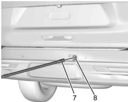
4. 将加长件开口端（7）插入并穿过后保险杠的孔（8）（升降轴检修孔）。
