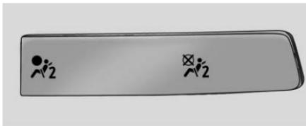
当车辆启动时，作为系统检查，乘客安全气囊状态指示灯会点亮启用和停用数秒。再过数秒之后，状态指示灯将点亮启用或停用，以告知您前排外侧乘客正面安全气囊的状态。
