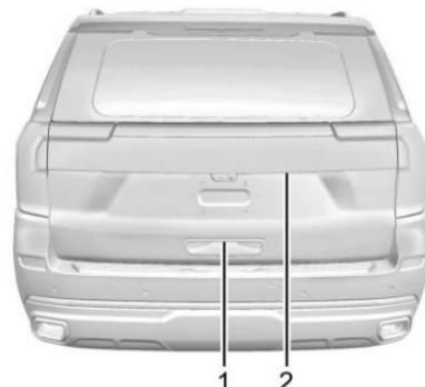
要打开尾门，按下电动门锁开关上的 $\text{■}$ ，或者按下遥控钥匙上的 $\text{■}$ 两次，解锁所有车门。按下尾门把手底部的触摸板 (1) 并抬起。
