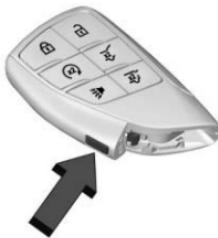
1. 按下遥控钥匙侧面的按钮，然后将机械钥匙拔出。未按下按钮时，绝对不得将机械钥匙拔出。
