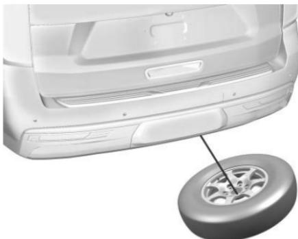
7. 将轮胎向车辆方向倾斜，使拉线留有一定的松弛度，以拆卸轮胎/车轮固定器。
