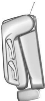
3. 再次拉动拉带，从地板上松开座椅后侧。座椅将向前翻转。
