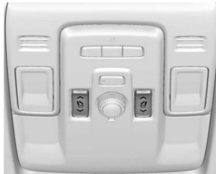
从顶置控制台（如配备）折叠座椅：车辆必须挂 P（驻车）挡时，此功能才起作用。
