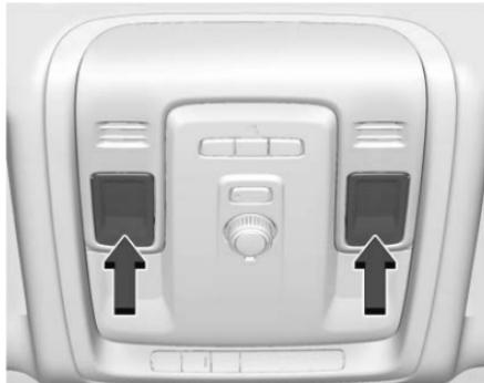
前部阅读灯位于顶置控制台中。按下灯罩可以打开或关闭前部阅读灯。
