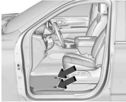
重新安装时，将地毯上的固定器开口与地板垫固定器对齐并卡入到位。
