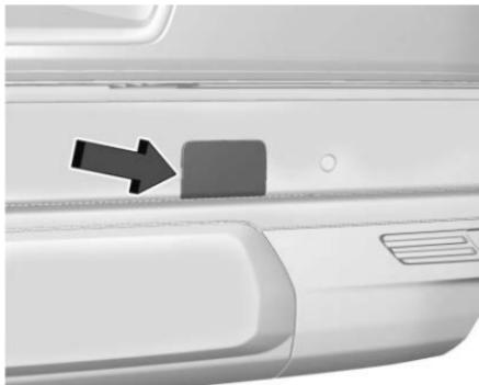
1. 打开保险杠上的升降轴检修孔盖 (3)，露出备胎锁 (6)。
