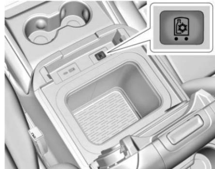
如果配备中央扶手箱制冷功能，提起扶手即可使用。扶手升起时，指示灯将点亮。
