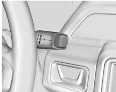
换挡模式显示在换挡杆前部。选择的挡位将会在换挡杆上呈红色亮起, 其他所有挡位则显示为白色。如果由于处于非常寒冷的条件下而无法立即换挡, 换挡开关上的指示灯可能会持续闪烁, 直到完全换入目标挡位。
